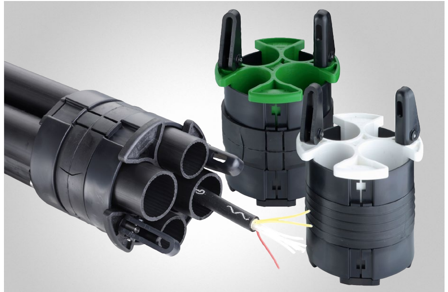
Teilbare Abdicht- und Fixierscheiben AdSe-t dichten den Hohlraum zwischen Kabelkanal-Rohr bzw. Halbbröhrzug und Mehrfachrohr ab.
